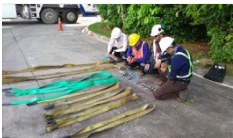
การตรวจสอบสภาพอุปกรณ์ทุกครั้งก่อนใช้งาน
